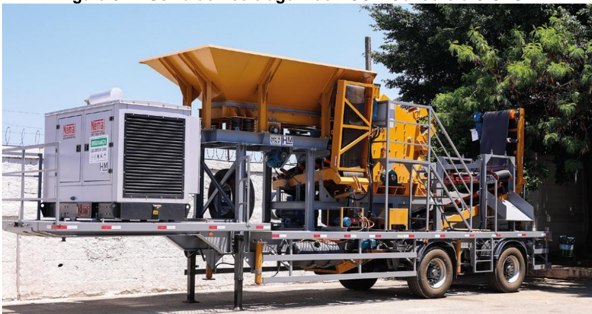
Figura 37 – Usina de Reciclagem de RCC – Consórcio CIOESTE
