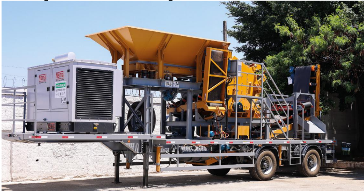
Figura 37 – Usina de Reciclagem de RCC – Consórcio CIOESTE
